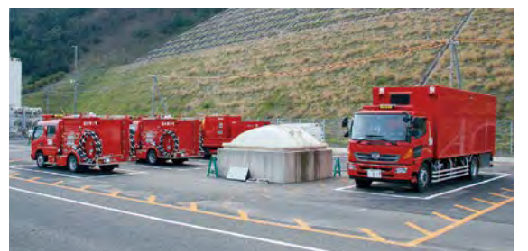
消防車/柏崎刈羽発電所の火災を機に導入し福島事故で増設消火だけでなく、電源喪失時に消防車から冷却水を給水できるよう、システムの構築と訓練を行っている
