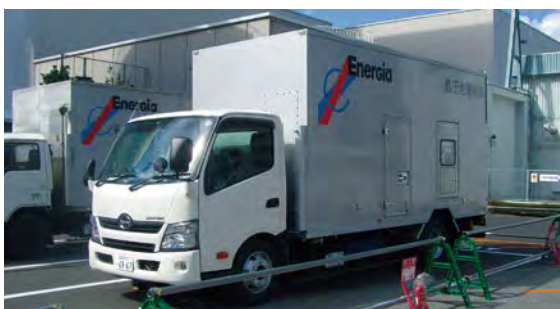
高圧発電機車/原子炉を冷却するための最低限必要な電源を供給することができる
